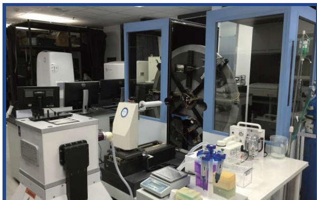
光学-结构-核素多模态融合成像系统 (获国家自然科学基金委重大仪器专项支持)
